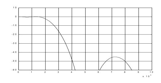
Figure 34-2. Frequecy response, EQ-FIR+COMB<sup>4</sup>
